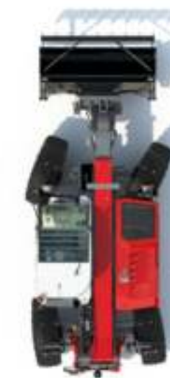
SEMI-HUNDEGANG-LENKMODUS mit definiertem Hinterrad-Winkel – nützlich für Anwendungen wie Silagearbeiten und Stallreinigung.
