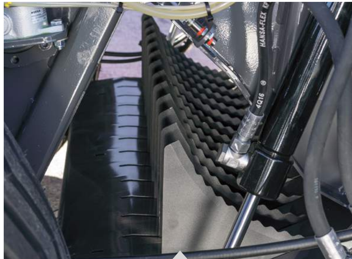
Der Rotor Xtracut 13 verfügt über eine theoretische Schnittlänge von 90 mm
