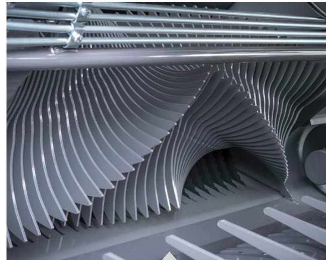
Der Rotor Xtracut 25 im spiralförmigen 4-Blatt-Design liefert extreme Schnittleistung
