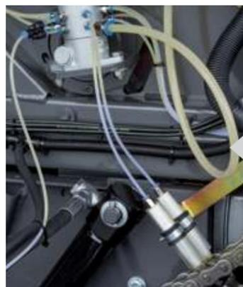
Die automatische Kettenschmierung beinhaltet eine individuelle Anpassung für jede Kette und gewährleistet eine optimale Ölzufuhr, wodurch die Wartungszeit verringert und die Lebensdauer der Ketten verlängert wird. Für maximale Langlebigkeit werden bei den Ballenpressen ausschließlich Ketten von höchster Qualität verwendet.
