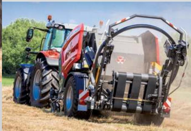
Für die Straßenfahrt wird der Wickeltisch nach vorne geklappt. Die Gesamtlänge beträgt nur sagenhafte 5,90m, der Transport ist sicher und die Wendigkeit nahezu wie bei der Solopresse!
