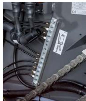
Eine regelmäßige und ausreichende Schmierung der Wellen- und Walzenlager ist überaus wichtig, insbesondere bei schwierigen Bedingungen, zum Beispiel beim Pressen von Silage. Zentrale Wartungspunkte zur Schmierung der Lager sind an gut zugänglichen Stellen positioniert und ermöglichen somit eine einfache und schnelle Wartung.
