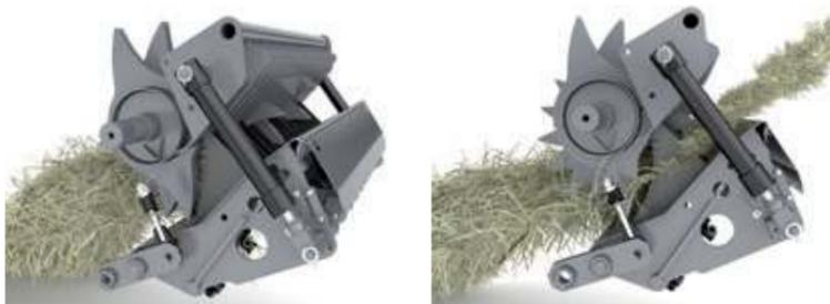
Das patentierte Schutzsystem verhindert durch ein behutsames Absenken des von Stahlfedern gehalten Bodens, dass es bei Spitzenbelastungen zu Verstopfungen kommt.
