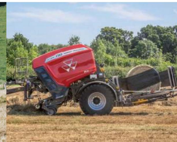
Für eine sanfte Ballenablage wird der Wickeltisch weit abgesenkt, was die Rotationsgeschwindigkeit des Ballens minimiert, eine Beschädigung der Folie verhindert und für eine gute Ballenform sorgt. Der optionale Ballenkipper bzw. Ballenaufsteller dreht die Ballen auf die flache Seite, verhindert so ein Wegrollen und erleichtert das Aufnehmen der Ballen bei der Verladung. Der Fahrer kann zudem zwischen einem automatischen und einem manuellen Entlademodus wählen.
