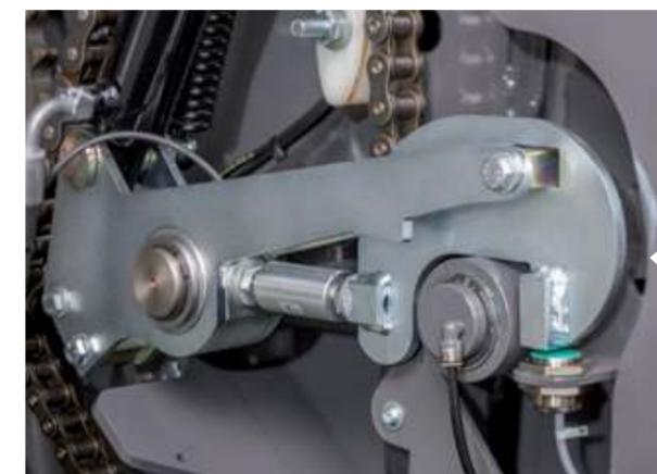
Die einfache und schnelle mechanische Heckklappenverriegelung wurde inzwischen auf beiden Seiten mit Drucksensoren optimiert, während eine Links-Rechts-Anzeige dem Fahrer ermöglicht, die äußeren Lagen des Ballens zu überwachen.
