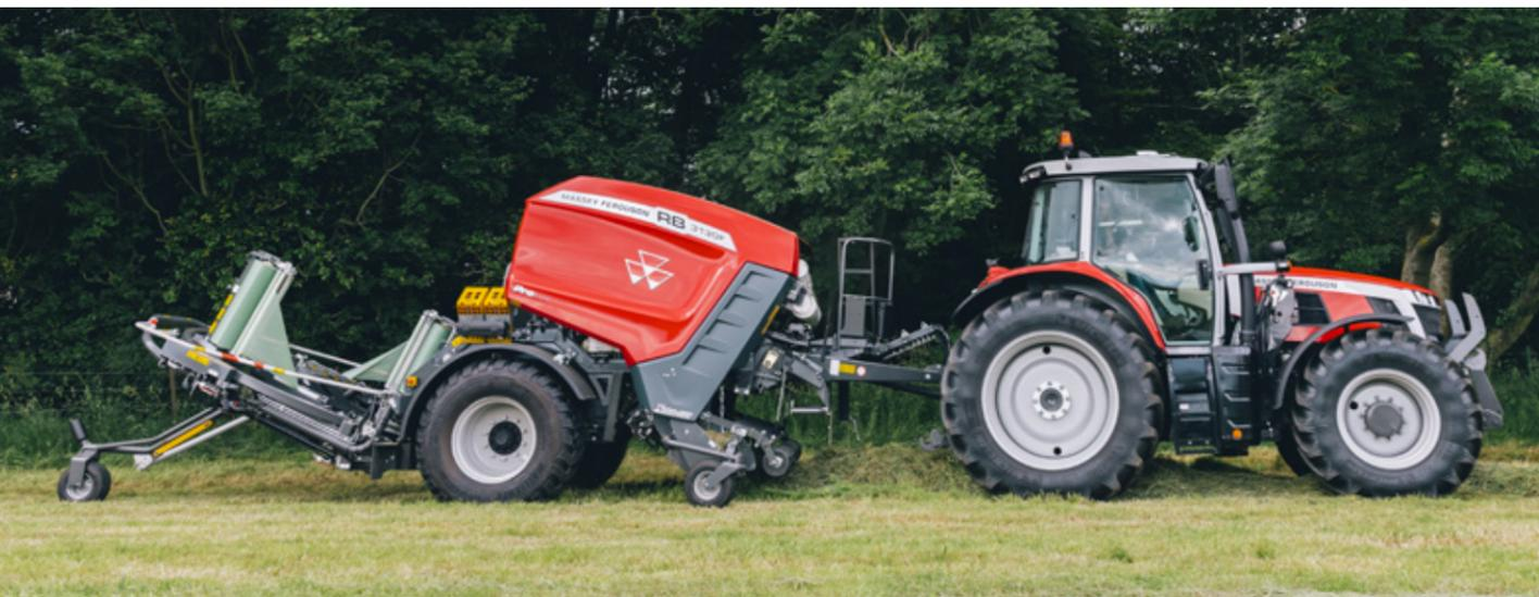
Das Powersplit-Getriebe teilt die Leistung gleichmäßig auf und überträgt sie entsprechend, um einerseits den Einzugsrotor und andererseits die Walzen anzutreiben, wodurch der Kraftbedarf sehr gering ist. Für die Maschinen der Baureihen MF RB F Xtra und MF RB F Protec ist jetzt auch ein leistungsstärkeres Getriebe mit 1.000 U/min erhältlich. Dieses sorgt für eine 20 % höhere Kraftübertragung, eine bessere Schnittqualität, selbst bei schwerstem Erntegut, und geringeren Kraftstoffverbrauch.
