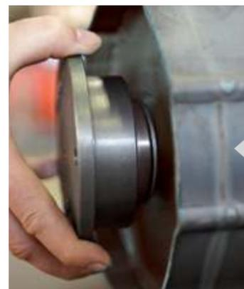
Auf die Ballenkammer wirken mitunter extreme Kräfte aus allen Richtungen. Das intelligente Design der Lagergehäuse ermöglicht ein gewisses Spiel der Walzen, sodass axiale Lastspitzen während des Pressens eliminiert werden.
