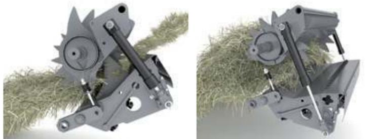
Im Falle einer Verstopfung kann der Fahrer den Förderkanalboden schnell und einfach öffnen und gleichzeitig die Messer absenken, damit das Material weiter zur Kammer gelangt.
