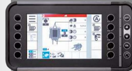
Die Steuerung E-Link Pro mit ISOBUS-Technologie ist bei der MF RB 3130 F Protec serienmäßig enthalten und bei der MF RB 3130 F Xtra optional erhältlich und verfügt über ein großes, helles Display, auf dem zahlreiche Parameter übersichtlich und gut lesbar angezeigt werden, sodass der Fahrer mehr Informationen und eine bessere Kontrolle über die Ballenpresse erhält. Die Press-Wickel-Kombination ist zudem für eine bessere Kontrolle des Wicklers mit einer Rückfahrkamera ausgestattet.
