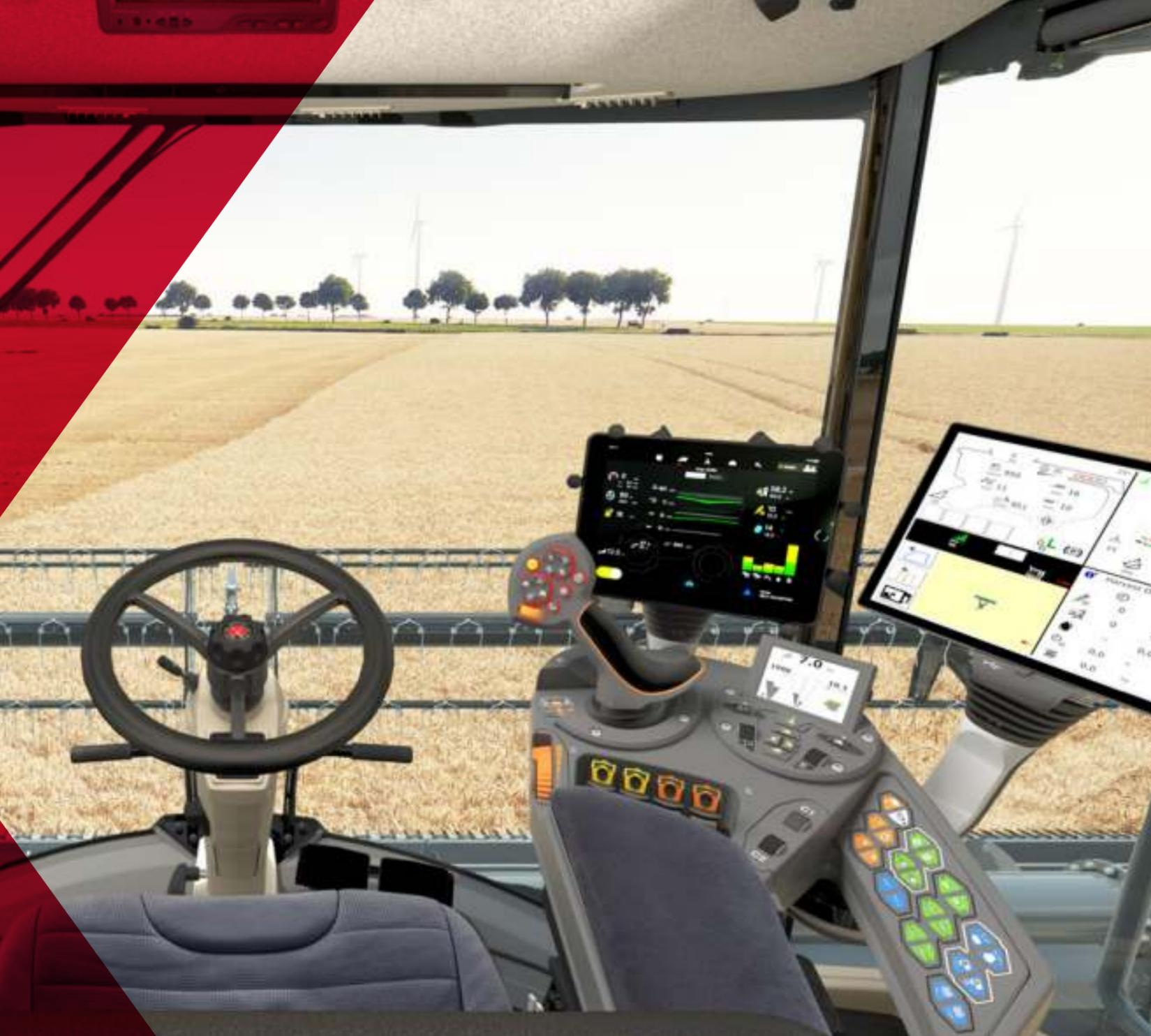
Auf die übersichtlich angeordneten Instrumente hat der Fahrer alle wichtigen Betriebsdaten stets im Blick. Das TechTouch-Terminal kann um bis zu 90° nach rechts geschwenkt werden. Dadurch bleibt die Sicht auch auf breiteste Schneidwerke perfekt.
