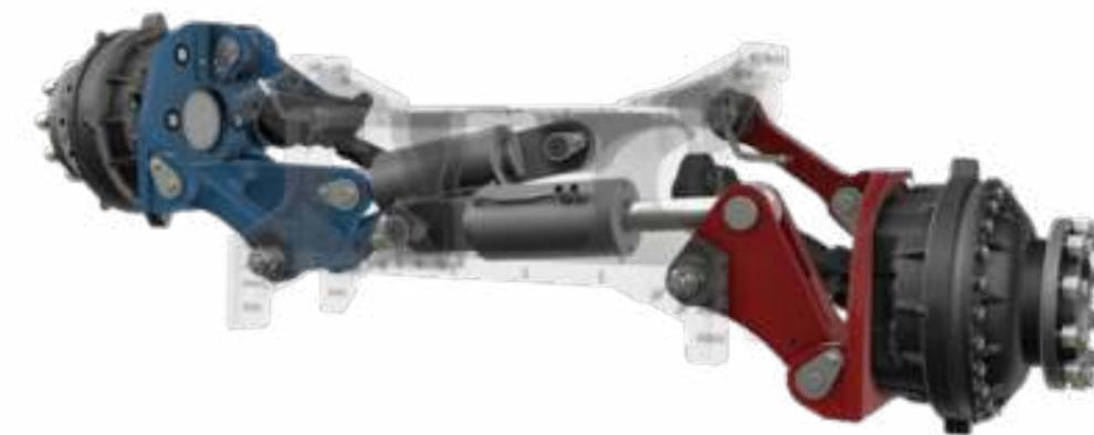
▲ **Sanfter Ausgleich** mit hydraulischer Proportionalventil-Steuerung steigert die Maschinenleistung an steilen Hängen
