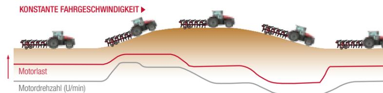
Im Automatikmodus regelt der Traktor je nach Last und Fahrgeschwindigkeit selbständig die Motordrehzahl. Die Bedienung ist sowohl per MultiPad Fahrhebel als auch per Fahrpedal möglich – für effizientes Arbeiten bei optimaler Kraftstoffeffizienz.
