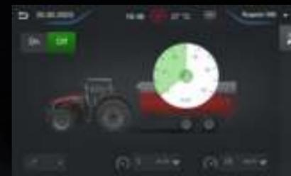
► **AUTOMATISCHE LENKACHSSTEUERUNG** – Mit dieser Funktion können Sie die Geschwindigkeit festlegen, bei deren Erreichen der Traktor die Lenkachse eines Anhängers automatisch sperrt – Sie müssen sich also auf der Straße keinerlei Gedanken mehr über die Sperrung der Lenkachse machen. Das gleiche passiert, wenn Sie den Rückwärtsgang einlegen.
