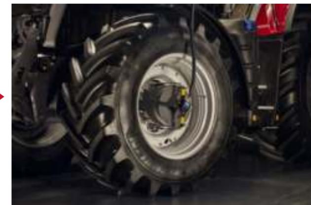
Die Reifendruckregelanlage reduziert den Kraftstoffverbrauch nachweislich um 10 % bis 15 % und verringert die Bodenverdichtung durch eine um 150 % größere Aufstandsfläche. Gleichzeitig kann die Traktion erhöht und unnötiger Reifenverschleiß minimiert werden.
