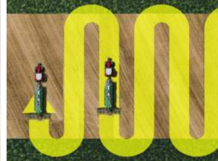
▲ **SPEEDSTEER** entlastet den Fahrer und ermöglicht schnelleres Wenden am Vorgewende. Der Fahrer kann die Lenkübersetzung anpassen und die Anzahl der Lenkradumdrehungen für einen bestimmten Lenkeinschlag einstellen.
