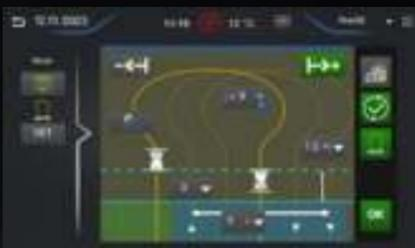
► **MF AutoTurn** – eine neue Funktion von MF Guide, die den Traktor automatisch in die nächste Spur lenkt – dank dreier Lenkungsmodi, die an die jeweilige Arbeit angepasst sind. Zwei Vorgewende-Sequenzen und ein neues Vorgewende-Management-System verwenden die GPS-Position, um die richtigen Sequenzen auszulösen.
