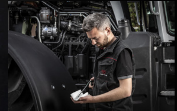
Das Design der Vorderachse und der übersichtlichen Motorhaube erleichtert den Zugang zum Ölpeilstab und zum Ölfilter.
