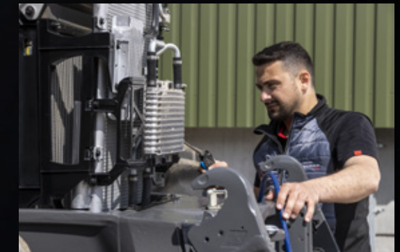
Das Kühlerpaket ist leicht zu erreichen und lässt sich dadurch bequemer und schneller reinigen.
