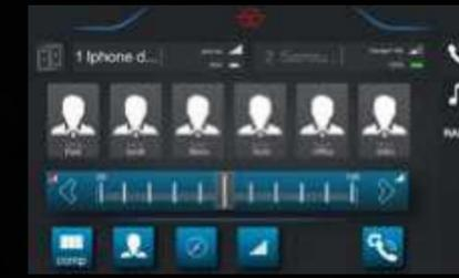
Zugriff auf Radiofunktionen via Datatronic 5: Wie in einem Pkw können Sie ganz einfach verschiedene Geräte per Bluetooth, USB oder AUX-Anschluss mit dem Radio verbinden und zudem optional mehr als ein Smartphone synchronisieren. Sie können Radiosender programmieren, Anrufe tätigen und entgegennehmen und verschiedene andere Funktionen nutzen.
