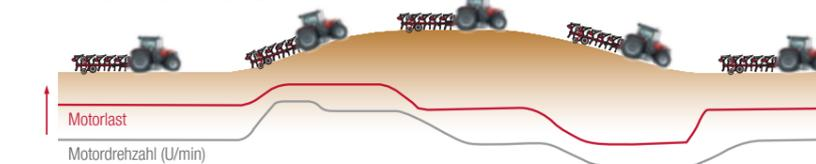
Das renommierte kontinuierlich-variable Dyna-VT Getriebe verfügt nun auch über einen Automatikmodus. Dies erlaubt es dem Fahrer, mithilfe des MultiPad-Fahrhebel oder des Fußpedals die Fahrgeschwindigkeit zu verändern, während abhängig von Last und Geschwindigkeit automatisch die optimale Motordrehzahl ausgewählt wird. Dies ermöglicht ein besonders geschmeidiges Arbeiten und erhöht die Kraftstoffeffizienz.
