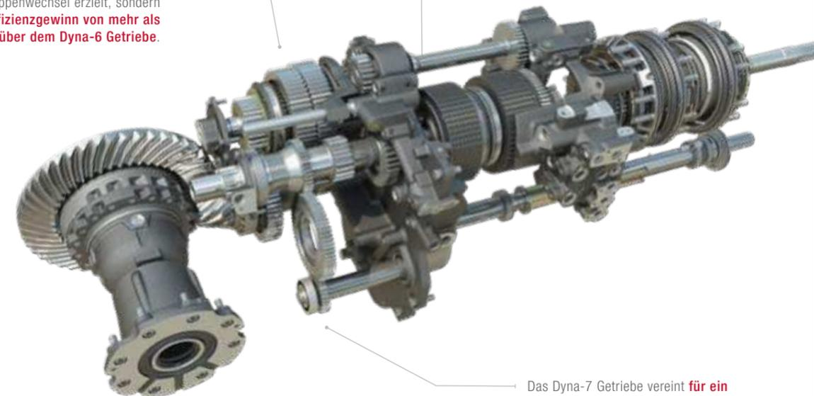
Das Dyna-7 Getriebe vereint **für ein außergewöhnliches Fahrerlebnis komfortable Bedienung** mit höchster Wirtschaftlichkeit. Das einzigartige Dyna-7 Getriebe bietet in allen vier Gruppen eine sanfte 7-Stufen-Dynashift-Schaltung, sodass für maximale Produktivität im Feld eine enorme Lastschalt-Flexibilität über einen großen Geschwindigkeitsbereich verfügbar ist. Dynashift- und Gruppenwechsel können dabei unter Last vorgenommen werden, ohne das Kupplungspedal zu betätigen.
