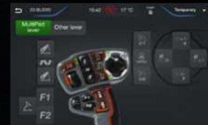
ISOBUS MultiPad Tastenzuweisung – ISOBUS-Arbeitsgeräte können direkt über den MultiPad-Fahrhebel bedient werden. Die Anordnung aller Bedienelemente (für Traktor und Arbeitsgerät) auf einem Hebel ist deutlich bequemer als die Verwendung zusätzlicher Anzeigen und Hebel.
