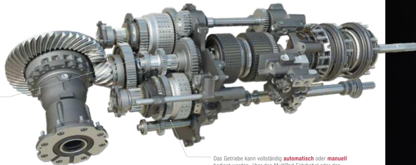
Das Getriebe kann vollständig **automatisch** oder **manuell** bedient werden, über den MultiPad-Fahrhebel oder den PowerControl-Hebel. Darüber hinaus kann je nach Aufgabe und Arbeitsbedingung festgelegt werden, wie aggressiv und schnell die vollautomatischen Gruppenwechsel erfolgen.
