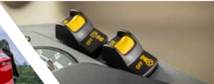
Elektrohydraulisch vorgewählte Zapfwellendrehzahl
