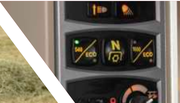
Elektrohydraulisch vorgewählte Zapfwellendrehzahl
