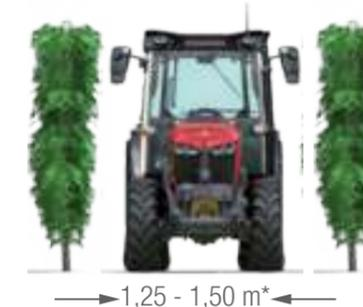
Der MF 3SP ab 1,25 m Breite wurde für Weinberge mit breiteren Reihenabständen konzipiert. Das Modell besitzt eine geräumigere Kabine und Motorleistungen von 75 PS bis 120 PS.
