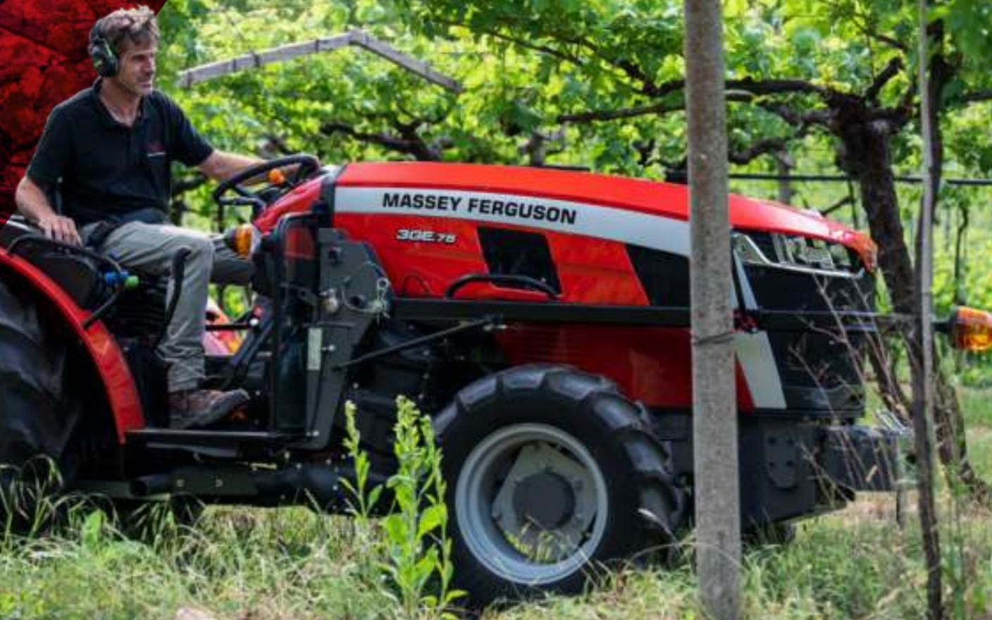
**DIE 75-PS-EINSTIEGSMODELLE DER BAUREIHE MF 3 SPEZIAL SIND MIT NEUESTEN 3,4-LITER-VIERZYLINDERMOTOREN DER STUFE V AUSGESTATTET. WIE DIE LEISTUNGSSTÄRKEREN MODELLE SIND AUCH DIESE MIT DERGLEICHEN AUSWAHL AN ESSENTIAL- ODER EFFICIENT-AUSSTATTUNGSPAKETEN ERHÄLTICH.**
