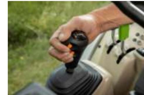
▲ Neuer Schalthebel mit Bowdenzug für einfache Bedienung.
