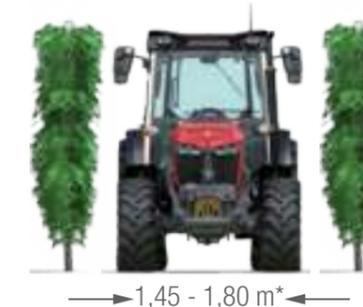
Der MF 3FR ab 1,45 m Breite eignet sich perfekt für weit auseinander liegende Reihen und ausgedehnte Plantagen. Der gut ausgestattete Traktor mit breiterer Vorderachse ist erhältlich von 75 bis 120 PS und als Plattformversion mit bis zu 105 PS.
