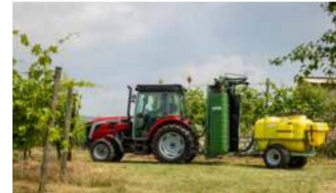
▲ Für den Landwirt steht der Ernteerlös an erster Stelle. Für Massey Ferguson ist es die Gesundheit des Landwirts und seiner Fahrer! Daher ist für mehr Sicherheit beim Spritzen optional ein Kabinenfiltersystem der Kat. 4 erhältlich. Über einen Schalter wird der Druck in der Kabine für einen optimalen Schutz von Kat. 2 auf Kat. 4 erhöht.
