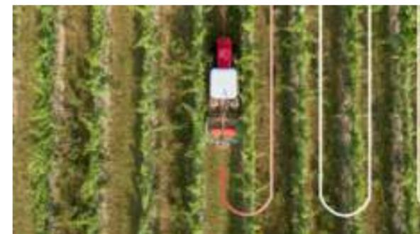
▲ SpeedSteer erleichtert und beschleunigt das Wenden des Traktors erheblich und erlaubt dem Fahrer die Anpassung der Lenkübersetzung.
