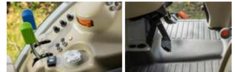
▲ Die neue elektronische Hubwerksregelung (EHR) ermöglicht eine präzise und einfache Bedienung - serienmäßig bei der Version Efficient und als Option bei Essential-Modellen erhältlich.
