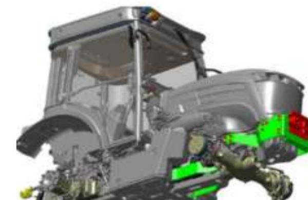
▲ Universelle Arbeitsgeräteträger, seitlich und/oder in der Front sorgen für maximale Kompatibilität mit den Arbeitsgeräten zahlreicher Hersteller.
