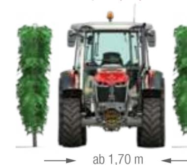
Der vielseitige MF 3AL ist mit einer Kabine mit ebenem Boden oder in einer Niedrigversion erhältlich und für hügeliges Gelände konzipiert. Dank der 1,40 m breiten Kabine eignet er sich perfekt als leichter Allzwecktraktor und kann mit Leistungen von 75 PS bis 105 PS geordert werden.
