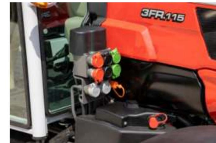
▲ Sie haben die Wahl zwischen Doppel- oder Dreifachpumpen sowie der erforderlichen Anzahl an mittig montierten Ventilen bzw. Kupplungen.
