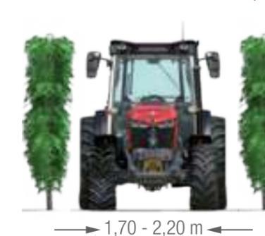
Ab einer Breite von 1,70 m und mit einer breiteren Vorder- und Hinterachse eignet sich der MF 3WF für den Obstbau und Arbeiten in Hanglage. Er ist mit Leistungen von 75 PS bis 120 PS und in der Plattformversion bis 105 PS erhältlich.
