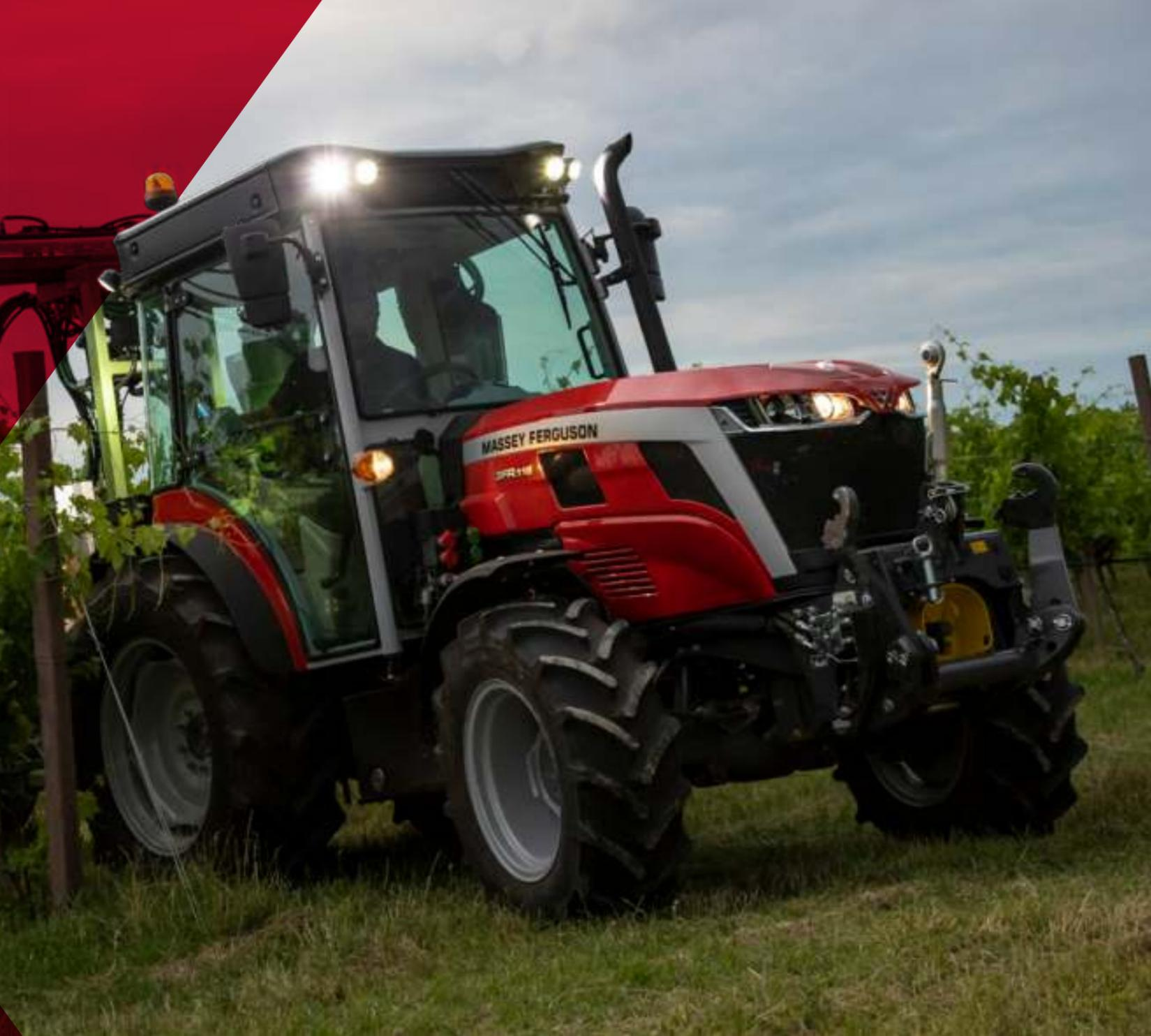
◀ Bei Einbruch der Dunkelheit kann die Arbeit dank der acht optionalen LED-Arbeitscheinwerfer fortgesetzt werden.
