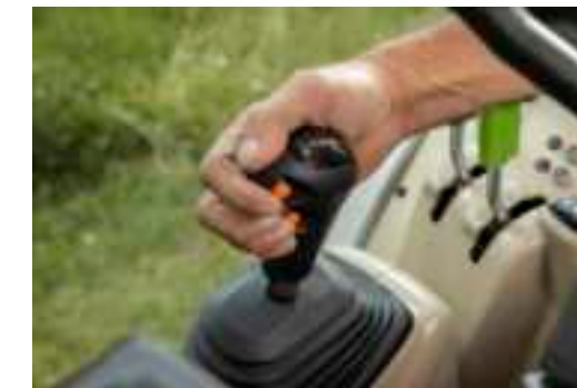
▲ Schalthebel mit Bowdenzug für einfache Bedienung.
