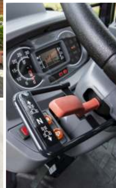
Für Modelle der Baureihe MF 1700 M: elektrohydraulischer Schalthebel für zusätzlichen Komfort
