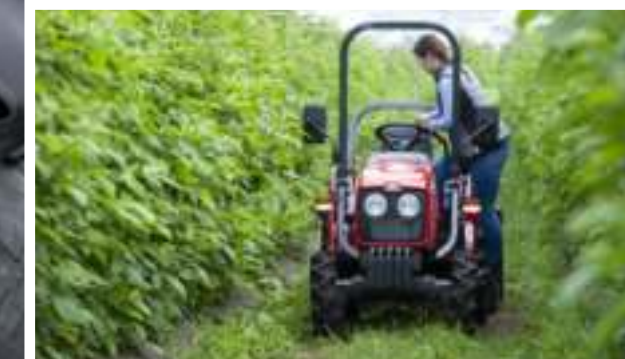
EINFACHER ZUGANG von beiden Seiten mit klappbarem Überrollschutz
