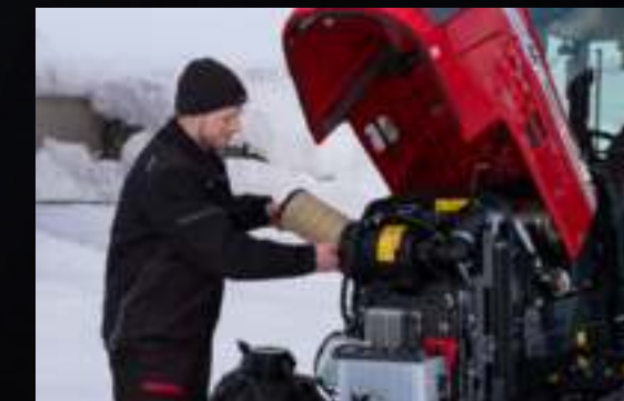
Die kompakte Kühleinheit ist bequem zugänglich, einfach zu reinigen und zu warten. Auch der Luftfilter des Motors ist bequem zugänglich und leicht zu reinigen.
