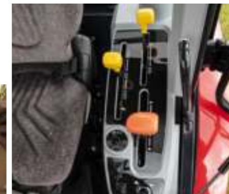
Farbcodierte Hebel ermöglichen eine schnelle, unkomplizierte Bedienung
