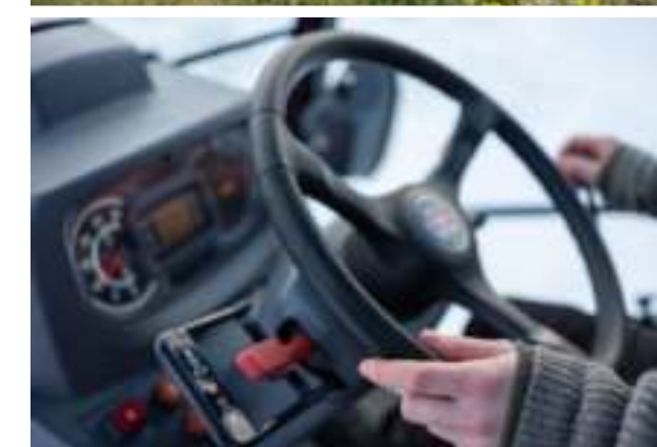
Mechanisches Getriebe mit PowerShuttle-Hebel beim MF 1700 M – 12x12 Getriebe-Gänge für maximalen Komfort bei jeder Anwendung.
