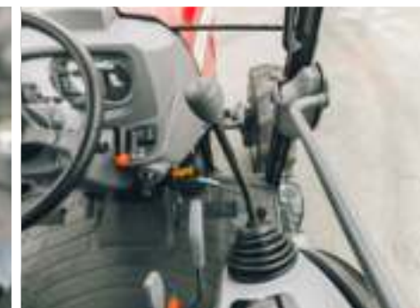
Mehr Komfort dank der schwenkbaren Lenksäule und des rechtsseitig montierten hydraulischen Joysticks zur einfachen und präzisen Steuerung von Anbaugeräten
