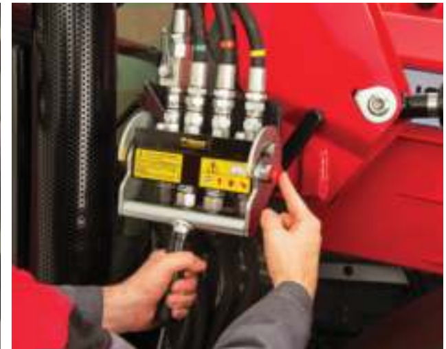
Hydraulische und elektrische Verbindungen trennen
