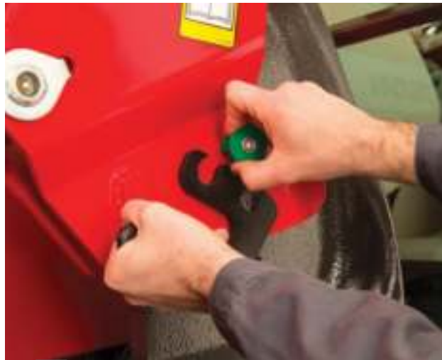
Arretierung lösen, dann Bolzen drehen und ziehen
