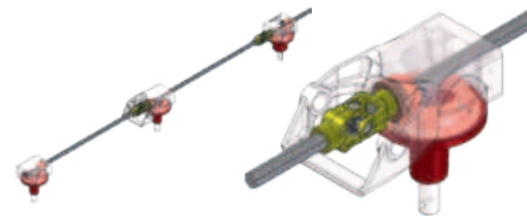
▲ Antrieb über starke Gelenkwellen und Kreuzgelenke
