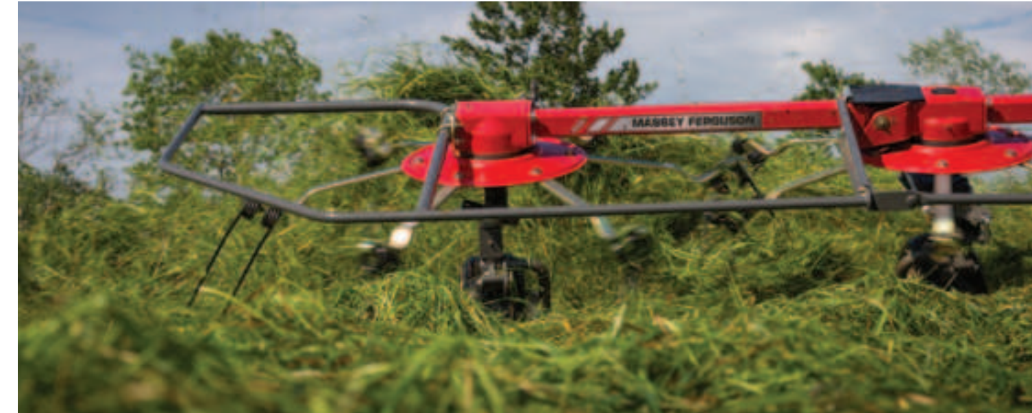
Gleichschenklige Zinken mit Kammeffekt
