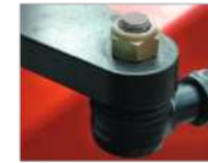
▲ Einstellbarer Lenkkopf der Spurstange
