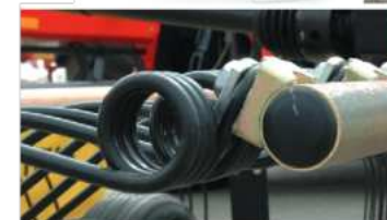
Vollkommen glatte Vorderkante der Zinkenarme
