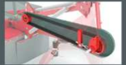
Keilriemenantrieb mit Überlastsicherung
