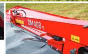
Mittenaufhängung mit hydraulischem Neigungsdämpfer
